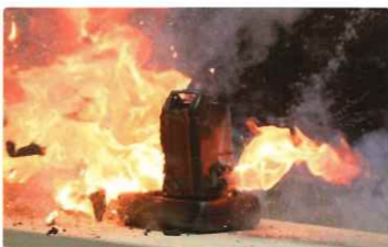
電動アシスト自転車用バッテリーが発火する様子
