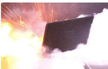
非純正バッテリー搭載製品の発火事故の再現
