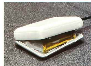
膨張したモバイルバッテリー
